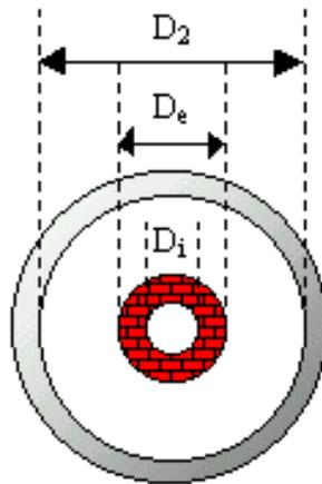
**Figura 13.** Sezione normale di uno scambiatore tubo in tubo
