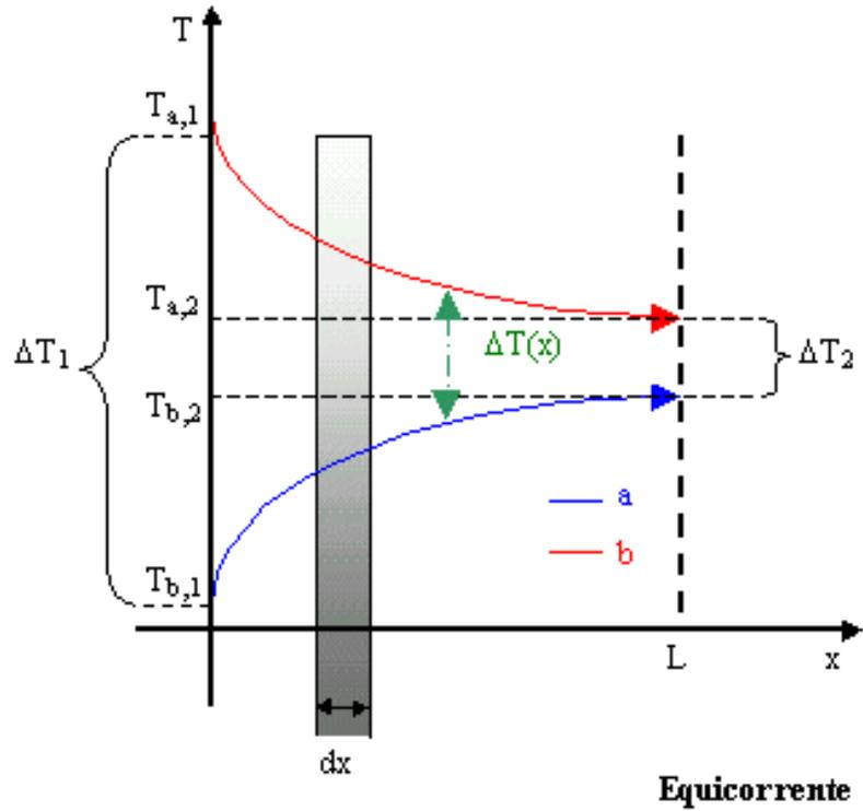
**Figura 4.** Grafico  $T(x)$  dello scaldatore in equicorrente.
