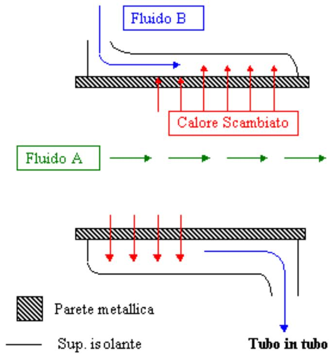
**Figura 12.** Scambiatore tubo in tubo
