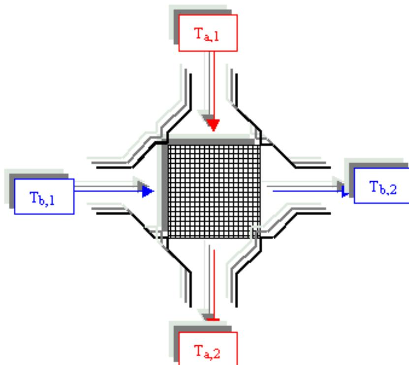
**Figura 9.** Scambiatore a correnti incrociate
