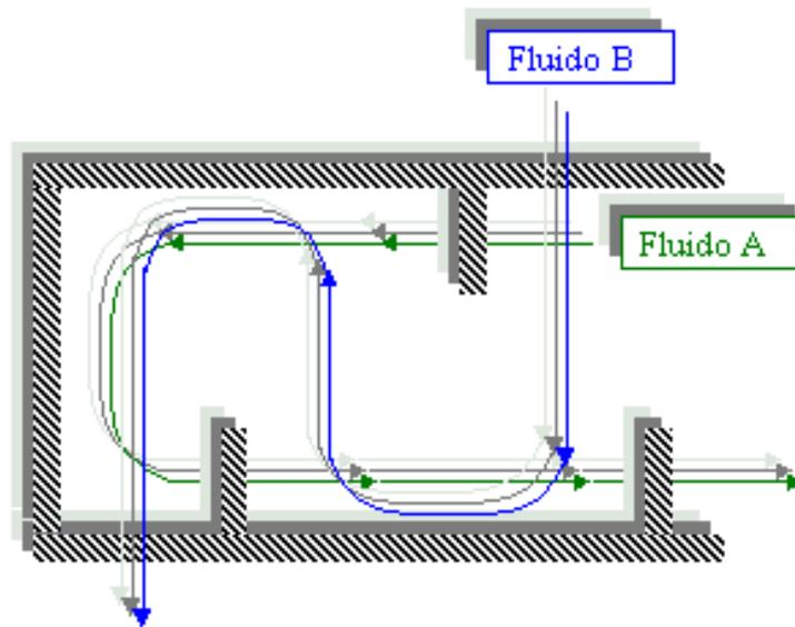
**Figura 8.** Scambiatore a doppio passo nel mantello.
