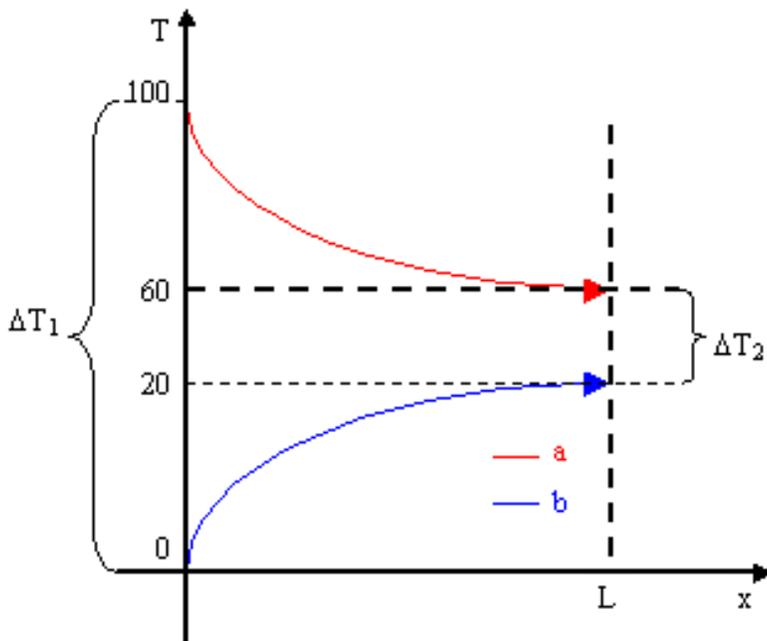
**Figura 6.** Diagramma  $T(x)$  in un caso particolare di scambiatore in equicorrente.
