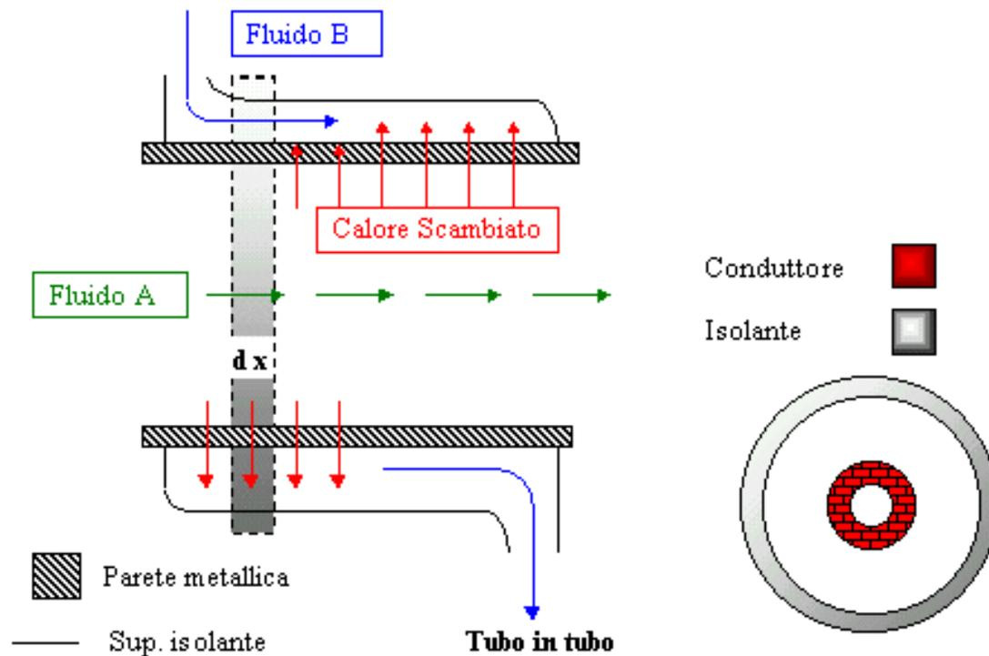
**Figure 2-3.** Sezioni longitudinale e normale di uno scambiatore tubo in tubo.
