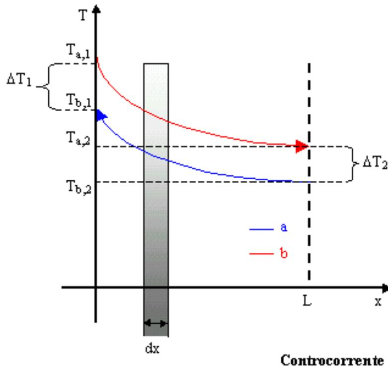
**Figura 5.** Grafico  $T(x)$  dello scaldatore in controcorrente.
