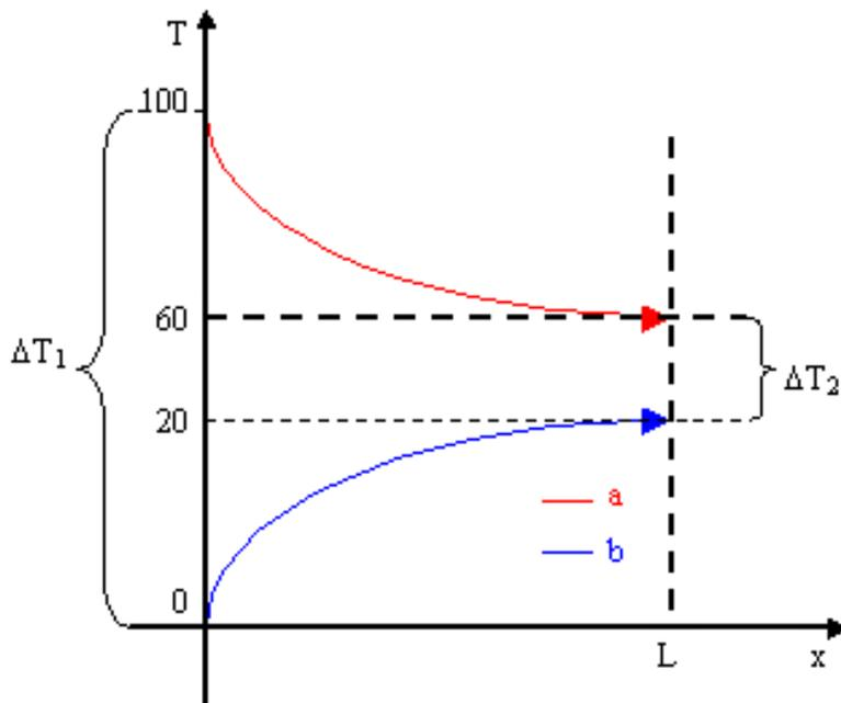
**Figura 7.** Diagramma  $T(x)$  in un caso particolare di scambiatore in controcorrente.
