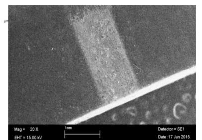
Ablazione Laser nanocompositi polimerici contenuti nanotubi di carbonio
